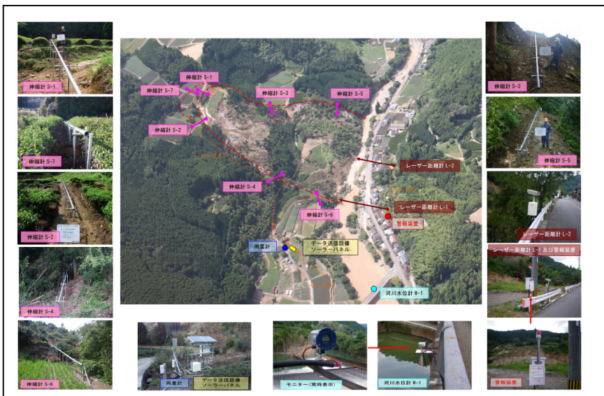
写真-1 地すべり自動観測システム概要
